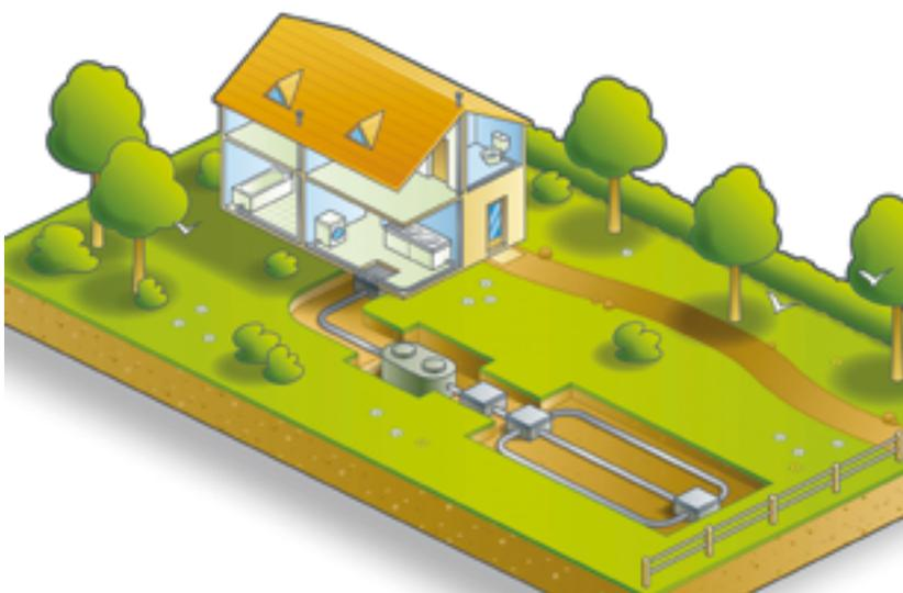
Schéma d'une installation d'assainissement non collectif
